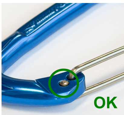
Foto 1: Rebite OK, extremidade arredondada em forma de «cogumelo»
